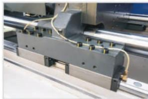
Piano mobile supportato da guide prismatiche di alta precisione. Colonne senza lubrificazione.
