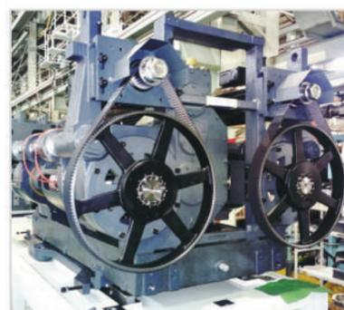
Azionamento dell'iniezione con due guide a ricircolo di sfere e due servomotori brushless sincronizzati.
