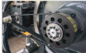
Sistemi di azionamento ad altissima precisione con motori brushless ed encoder assoluti
