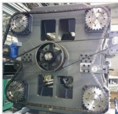
Movimentazione unità di chiusura con servomotori brushless in configurazione Master-Slave.
